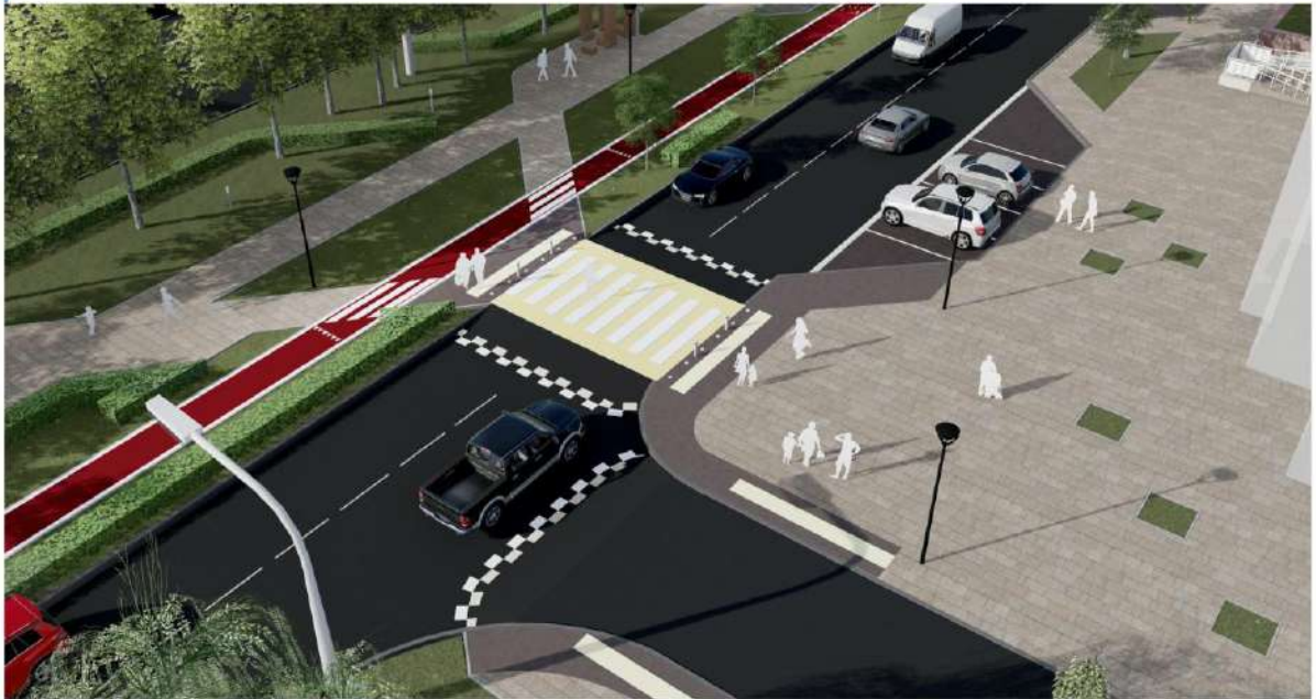
Узел В Нерегулируемый пешеходный переход и въезд на придомовую территорию
